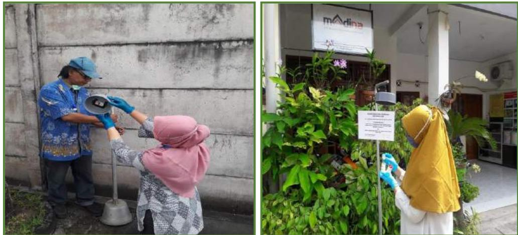
Pengambilan sampling udara ambien dengan *Passive Sampler*
